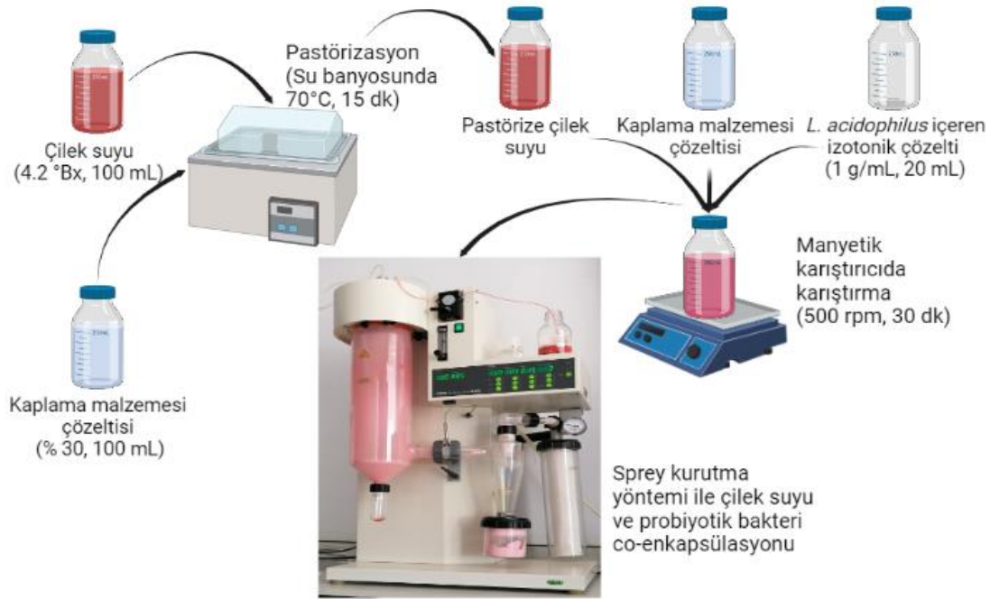
Şekil 1. Kapsülasyon öncesi son çözeltinin hazırlanması ve spray kurutma yöntemi ile co-enkapsülasyon
